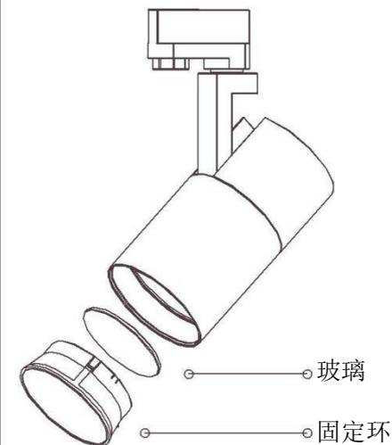
安装固定环内最多可以使用本公司的其中一种附件。要添加或更换新的附件时，打开固定环，添加或更换新的附件后，再将固定环装上。
